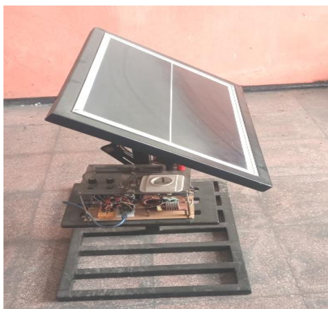
Gambar 9. MPPT test rangkaian pengisian baterai dengan panel surya
