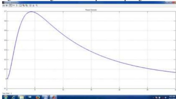
Settling time respon generator auto tuning terjadi pada waktu 30,8 detik. Dengan overshoot 0.7 saat 4.3 detik.
