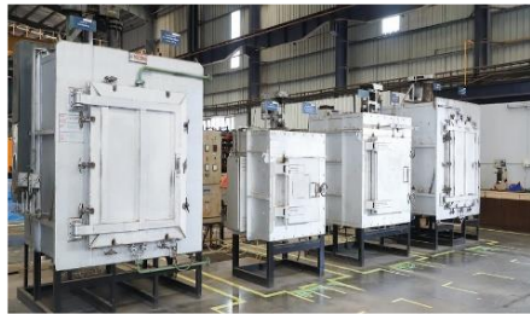
Gambar 1. Tungku untuk Proses Pembakaran
