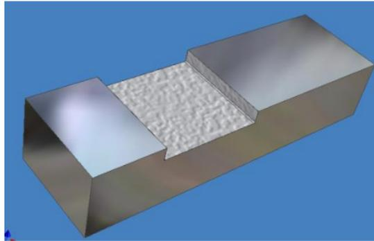
Gambar 2 Bentuk Benda Kerja Hasil Proses EDM Sinking
