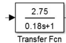
Gambar 1. Pemodelan Motor DC di Simulink
